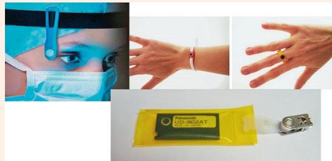
**Slika 3.** Termoluminiscentni dozimetri za mjerjenje izloženosti očne leće, šake ili kože te cijelog tijela.
