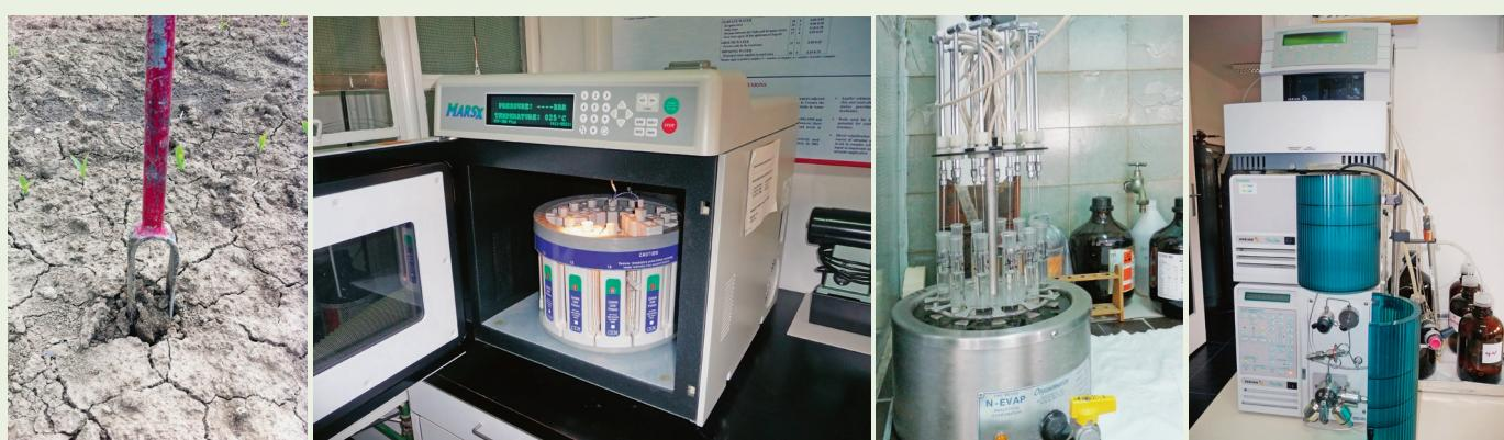
Slika 5. Od uzorka do kromatograma – četiri osnovne faze analitičkog postupka: uzorkovanje, izolacija analita iz matrice, ukoncentriravanje i tekućinsko-kromatografska analiza ekstrakta. Snimila: S. Stipičević.
