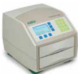
Trans-Blot Turbo; brzi transfer proteina s gela na membranu
