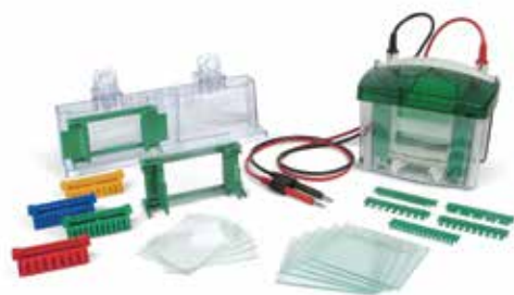
Mini-PROTEAN Tetra Cell; sustav za vertikalnu elektroforezu
